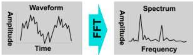
Gambar 1. Sinyal Getaran Berbentuk Waveform dan Spectrum dengan FFT
