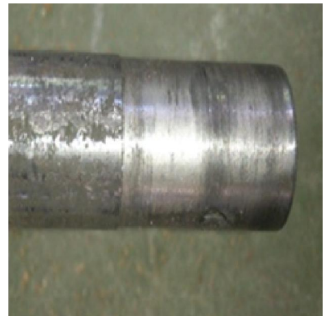
Gambar 2. Bentuk patahan dari samping
