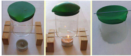
Gambar 1. udara dalam keadaan tekanan atmosfer (a), dipanaskan (b) dan didinginkan (c)
