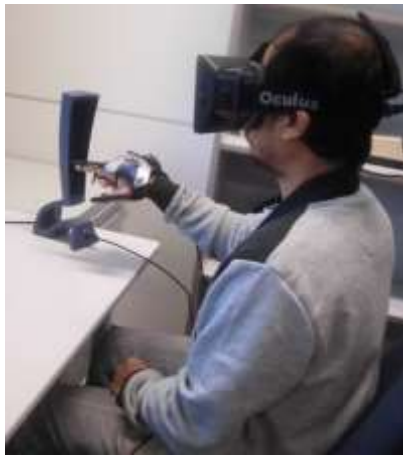
Gambar 2. Operator menggunakan glove sebagai pengendali, dan sinyal elektrik serta HMD untuk informasi haptic dan visual
