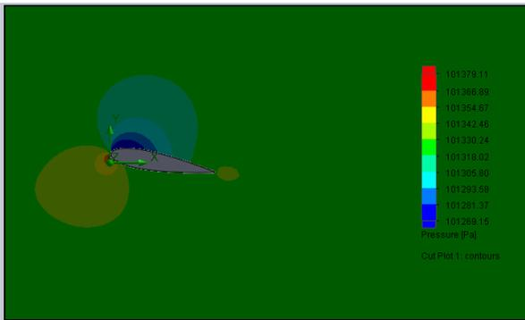
Gambar 10. Pressure contour saat  $\alpha = 10^\circ$
