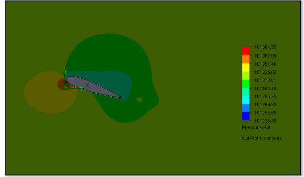
Gambar 12. Pressure contour saat  $\alpha = 20^\circ$
