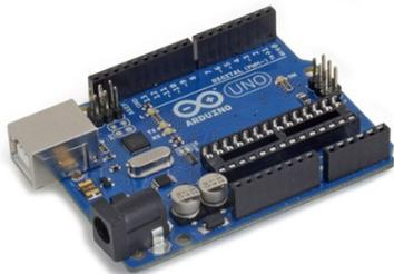
Gambar 2.1. Mikrokontroler Arduino
