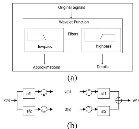
Gambar 6. Blok Diagram(a), Proses Dekomposisi dan Rekonstruksi Sinyal(b)
